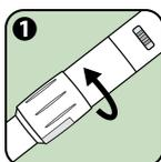
1. Ruotare completamente in senso anti-orario l'otturatore girevole delle finestrelle che espongono la soluzione come mostrato dalla freccia per allineare le lenti con le finestre dell'Auto-Iniettore.
