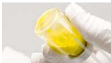
Polvere non passata in sospensione: grumi visibili
